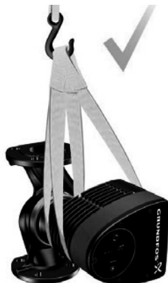
Рис. 7 Правильный способ строповки насоса
