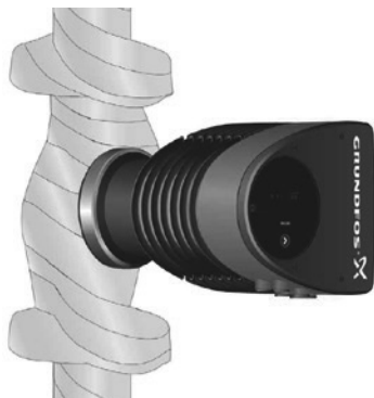
Рис. 17 Изоляция корпуса насоса и трубопровода
